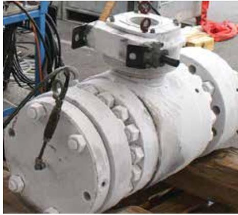
Tieftemperaturtests gehören bei einigen Hochleistungsarmaturen zum Standard
