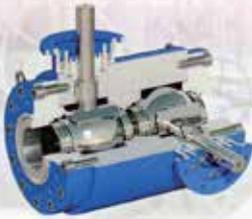
Das von Hartmann Valves entwickelte Twin Ball Valve (TBV) bietet eine doppelte Leitungsabspernung und ermöglicht es, die Sicherheit einer Anlage mit wenig Aufwand zu erhöhen. Konstruiert für Anwendungen mit besonders hohen Sicherheitsanforderungen besteht das TBV aus zwei Kugelhähnen, die auf Wunsch auch mit je zwei unabhängigen Barrieren ausgestattet sind. So kann im Vergleich
