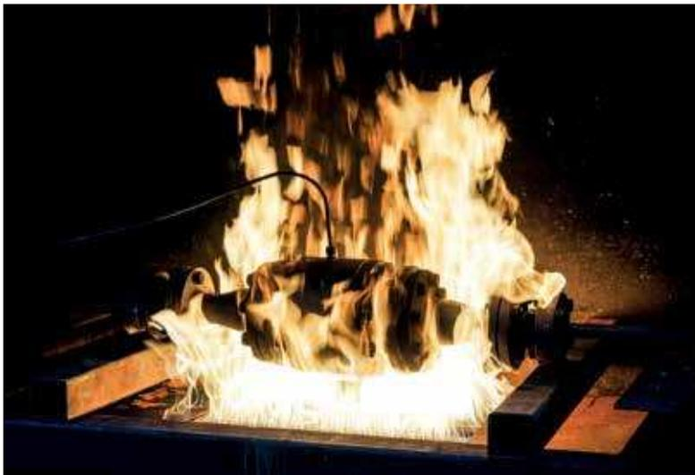
Fire-Safe-Tests gehören bei vielen Hochleistungsarmaturen zum Standard.
