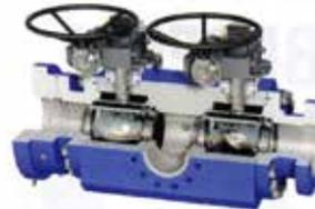
Das von Hartmann Valves entwickelte Twin Ball Valve (TBV) bietet eine doppelte Leitungsabsper-rung. Konstruiert für Anwendungen mit hohen Sicherheitsanforderungen besteht das TBV aus zwei Kugelhähnen, die auf Wunsch auch mit je zwei unabhängigen Barrieren
