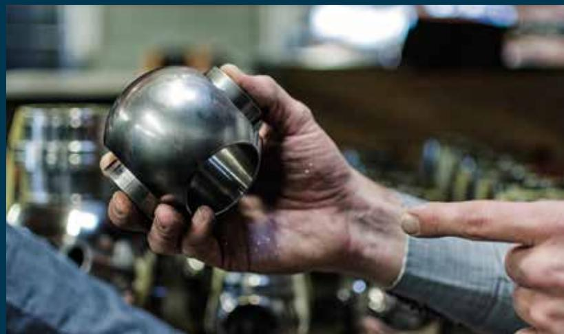
Abdichtung zwischen der Kugel und dem Dichtring entwickelt haben, die gasdicht ist und damit eine Leckrate von A bzw. 0 erfüllt und gleichzeitig extrem widerstandsfähig ist. Das ist eine Besonderheit, die uns hier neben vielen anderen Dingen auszeichnet.
