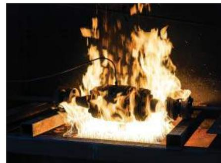
Fire-Safe-Tests gehören bei einigen Hochleistungsarmaturen zum Standard.
