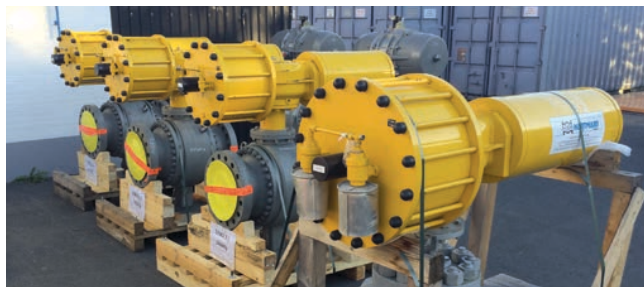
Die instandgesetzten Sicherheitskugelhähne sind bereit zum Rücktransport.
