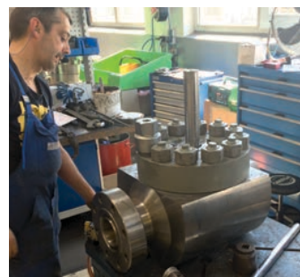
Ein überholter Kugelhahn (4 1/16“ PN520) bei der Montage im Hartmann Werk.
