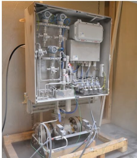
Das System muss extremen Temperaturen standhalten und wurde in einer Kältekammer einem Verschleißfestigkeitstest unterzogen.
