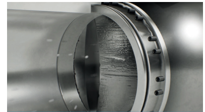
Eingelagerte Partikel beschädigen die Kugel.
