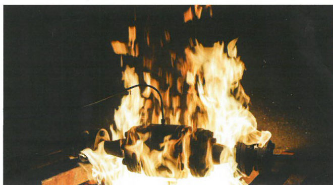
Fire-Safe Tests gehören bei vielen Hochleistungsarmaturen zum Standard
