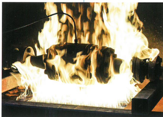
Fire-Safe-Tests gehören bei einigen Hochleistungsarmaturen zum Standard.
